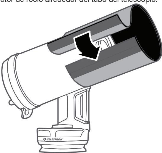
4. Cuando coincidan los extremos del lado opuesto de la muesca, las tiras de velcro deberían alinearse. Presione juntas con firmeza las tiras de velcro para asegurar el protector de rocío en posición.
