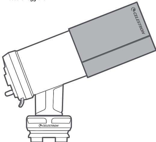
5. Verificare che lo scudo anti-rugiada sia fissato saldamente e dritto sul tubo del telescopio. Regolarne la posizione se necessario.
