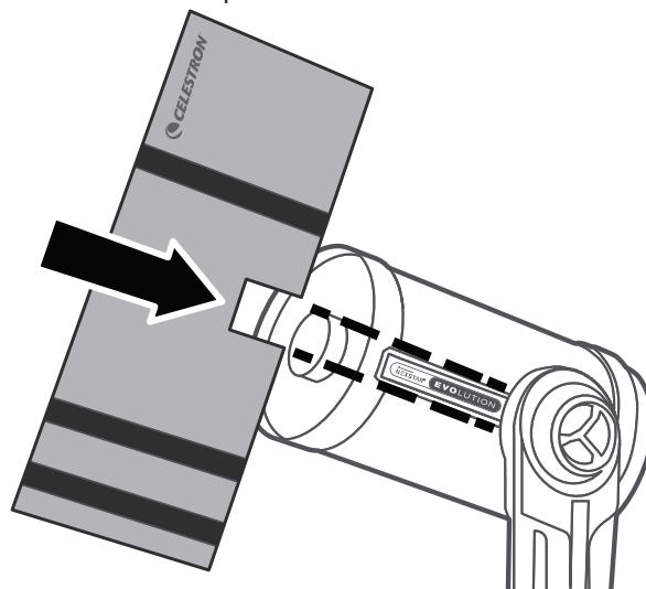
3. Tenere lo scudo anti-rugiada saldamente sul tubo del telescopio con una mano e, con l'altra, avvolgerlo intorno al tubo stesso.
